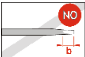
Fig. 8 Non utilizzare cacciavite con punta corta b) <7 mm
